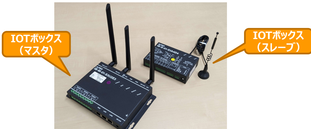
IoTボックス マスタ(手前)、スレーブ(奥) <1台のマスタに、3～8台のスレーブをWifiで接続>
